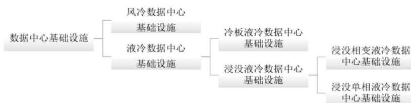
图4：现有主要产品为浸没相变液冷、冷板液冷数据中心基础设施产品等
