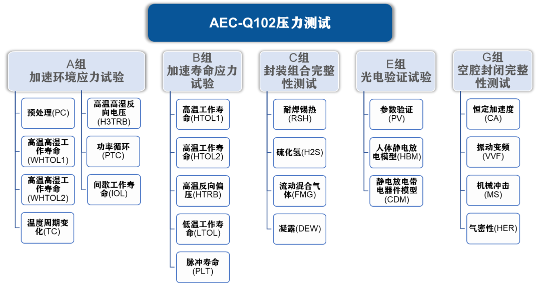
图表14: 车规要求高可靠低容错, AEC-Q102 压力测试项目包含数十项测试
