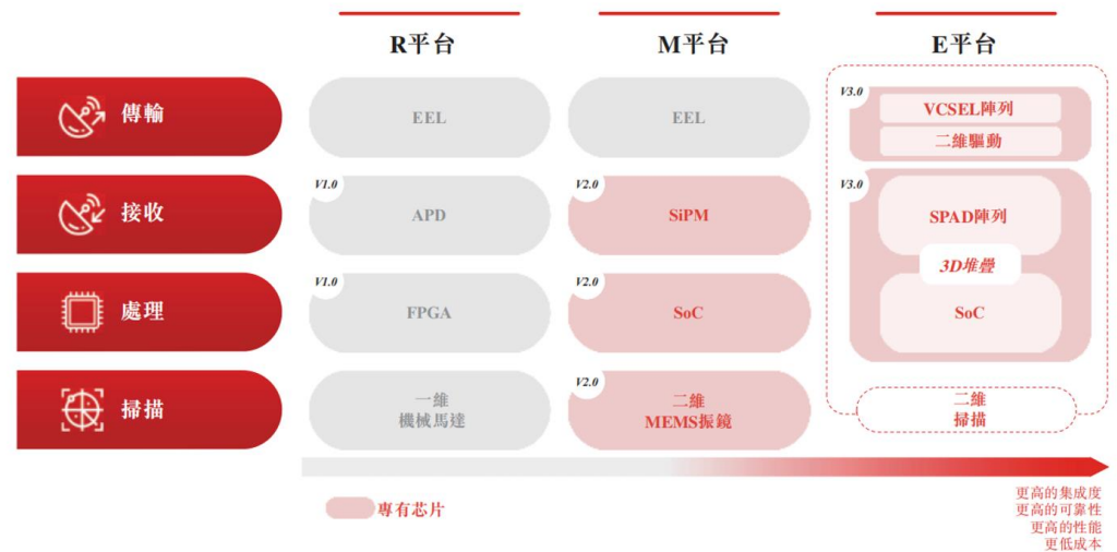
图表17: 速腾聚创芯片化研发思路推动激光雷达大幅降本
