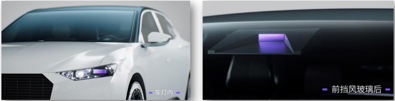
图表18: 车载激光雷达小型化优化物料成本, 解锁更多安装方式
