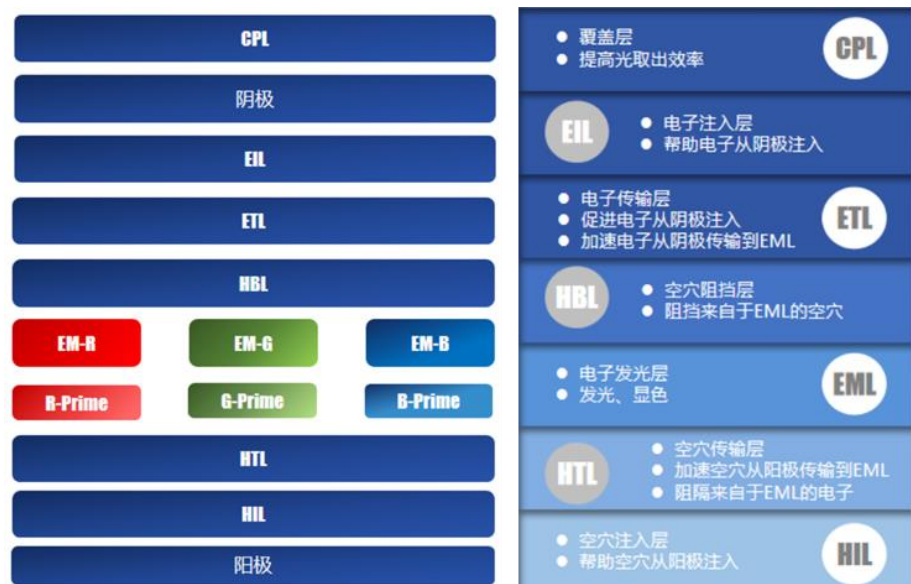
图 43：OLED 器件材料结构和作用
