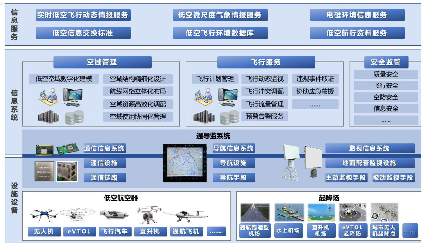
图9 低空航行系统构成
