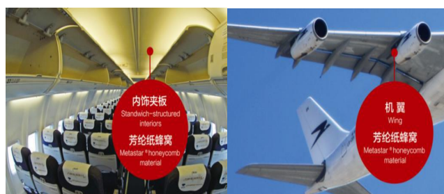
图表 32：芳纶纸蜂窝可用于内饰夹板与机翼
