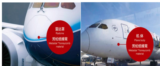
图表 31：芳纶纸蜂窝可用于飞机雷达罩和机体
