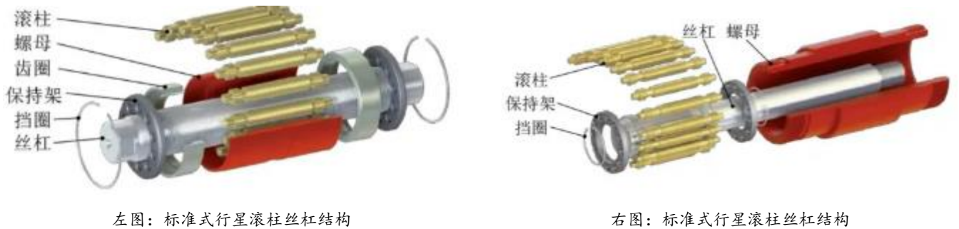
图表119：反向式行星滚柱丝杠与标准式行星滚柱丝杠结构特点
