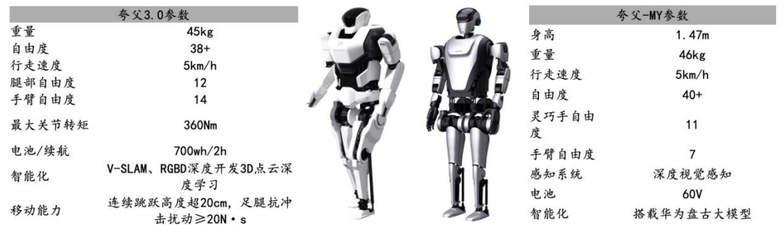
图表69: 夸父人形机器人接入华为盘古大模型
