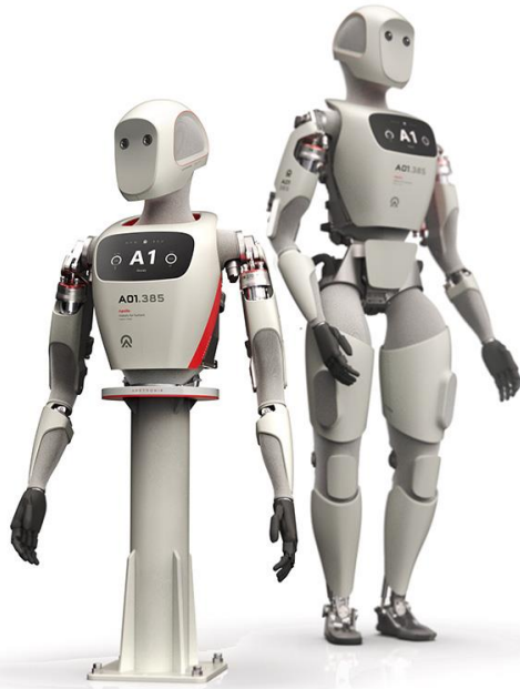
图表28: Apollo 人形机器人模块化设计
