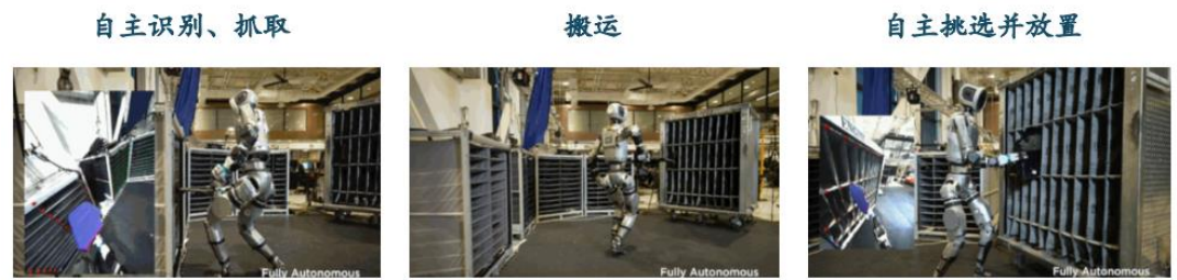
图表44: 电驱 Atlas 实现在工厂环境下完全自主抓取、搬运、放置汽车零部件
