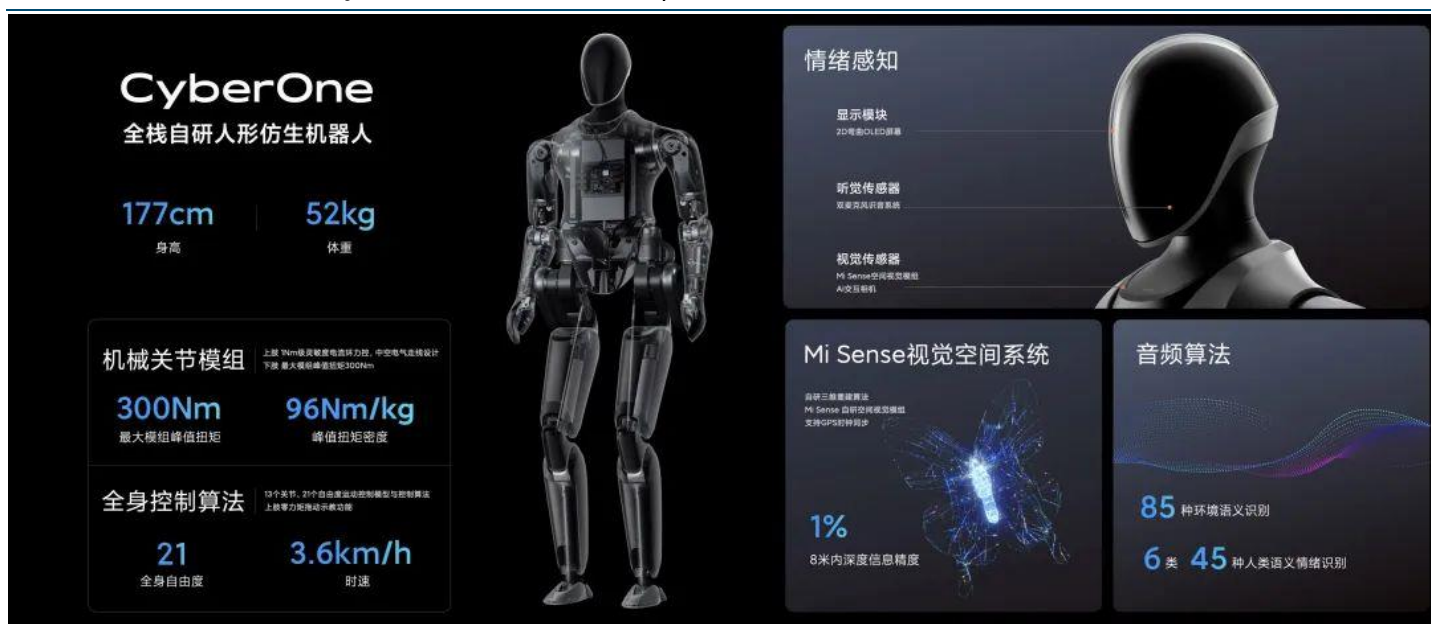
图表77: 小米人形机器人 CyberOne 全身 21 个自由度, 行走速度达 3.6km/h
