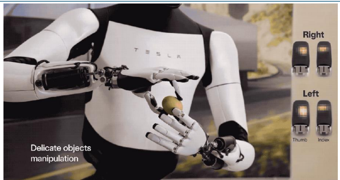
图表165: 特斯拉 OptimusGen2 灵巧手搭载触觉传感器轻松拿取鸡蛋
