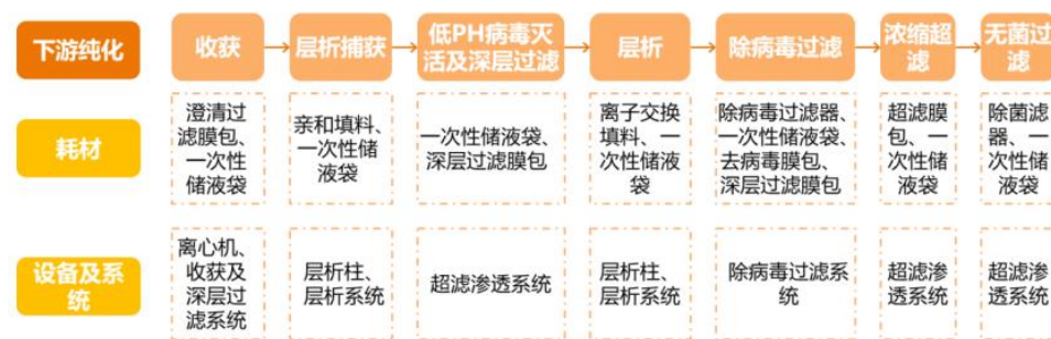
生物药分离纯化流程示意图
