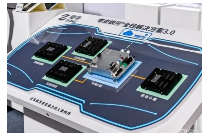
图38：零束银河智能车解决方案 3.0 实现舱驾一体的中央计算单元和整车中央协调运动控制器协同运作
