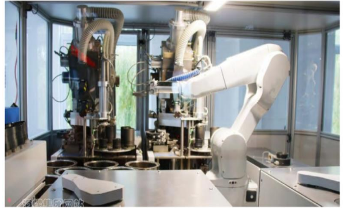
图10：海螺智能工厂智能质量控制系统自动制样机械手
