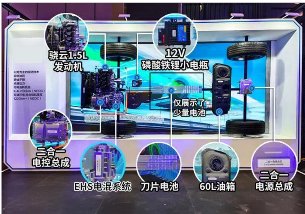
图10：比亚迪超级混动版 DM-i 架构拆解
