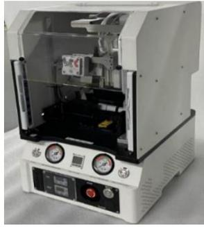
耳机硅胶套声学测试设备
