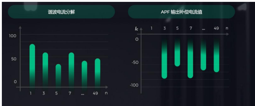
图表：APF识别各个谐波阶次的特征，实时同步分配补偿容量
