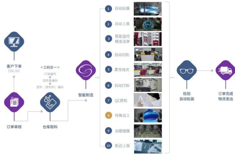
图 30：康耐特定制镜片生产流程
