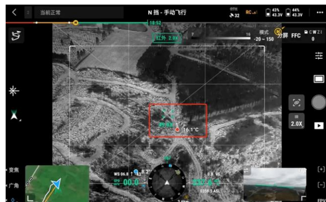
图23: 大疆无人机红外热成像功能, 可在 1 千米之外暗光场景感知并追踪
