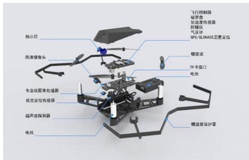
图21：无人机的结构部件与机器人具有交叉性
