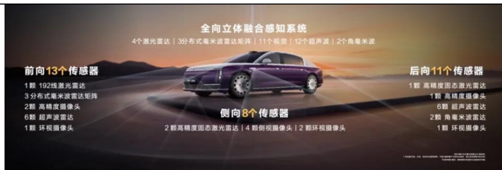
图53：尊界 S800 搭载 4 颗激光雷达，也有望实现 L3 级智驾能力
