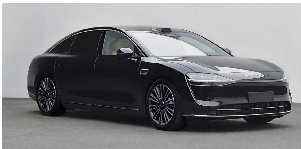
图54：尊界 S800 搭载 4 颗激光雷达，也有望实现 L3 级智驾能力
