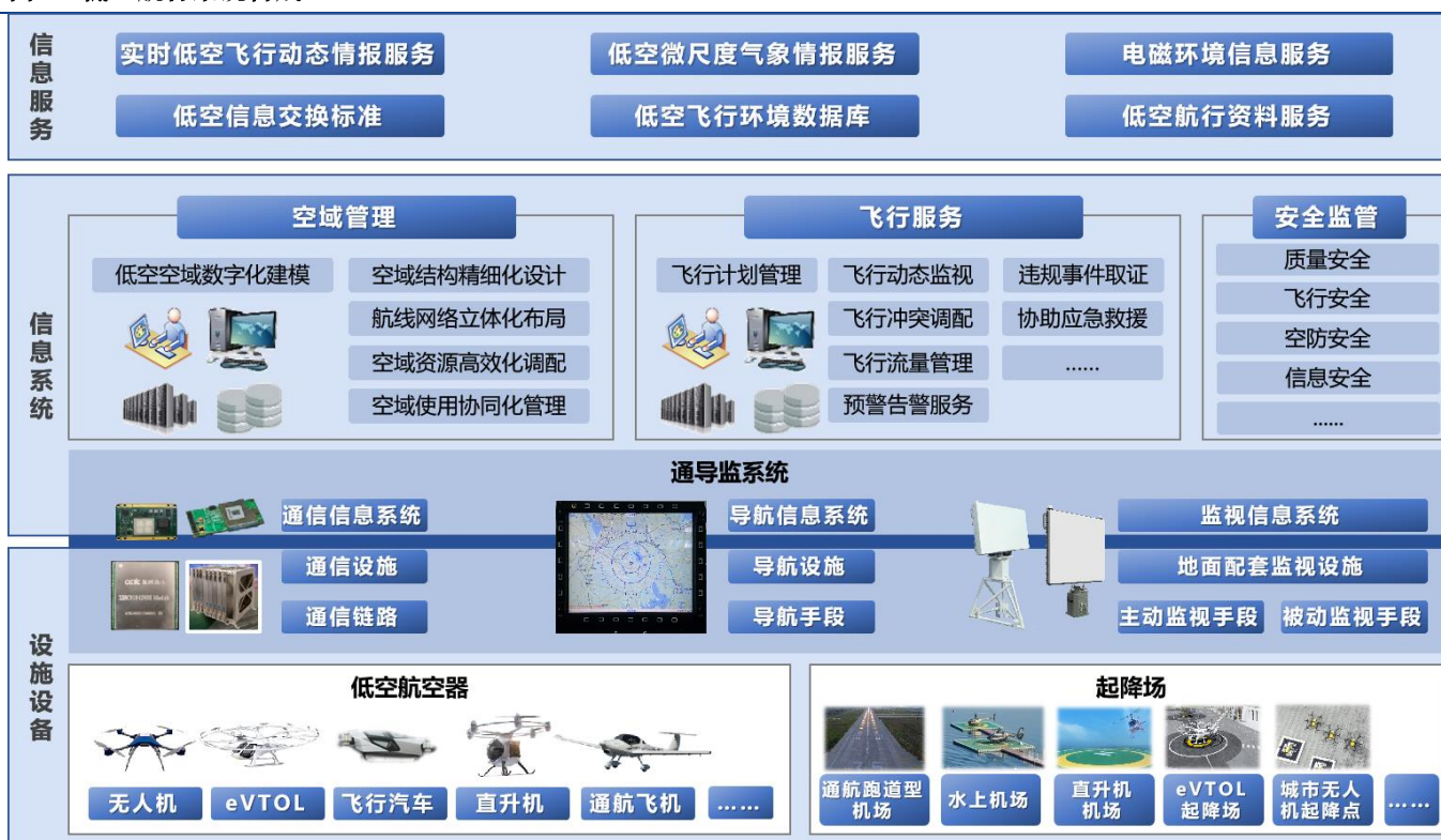
图18 低空航行系统构成
