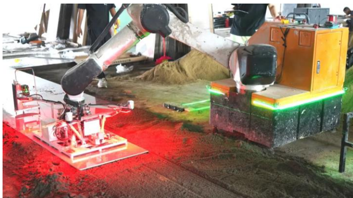
图表10：瓷砖铺贴机器人
