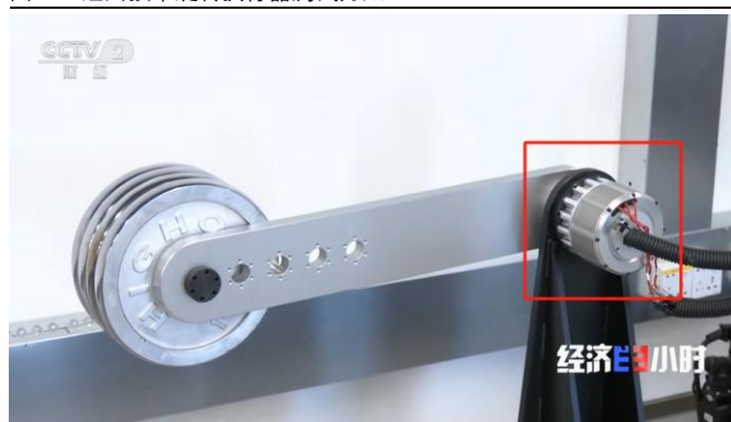
图 6：汇川技术旋转执行器测试力矩
