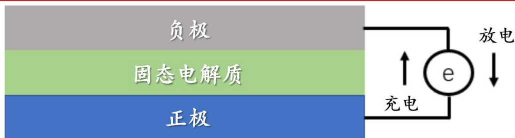
图表 44：固态电池由正极、负极和固态电解质组成
