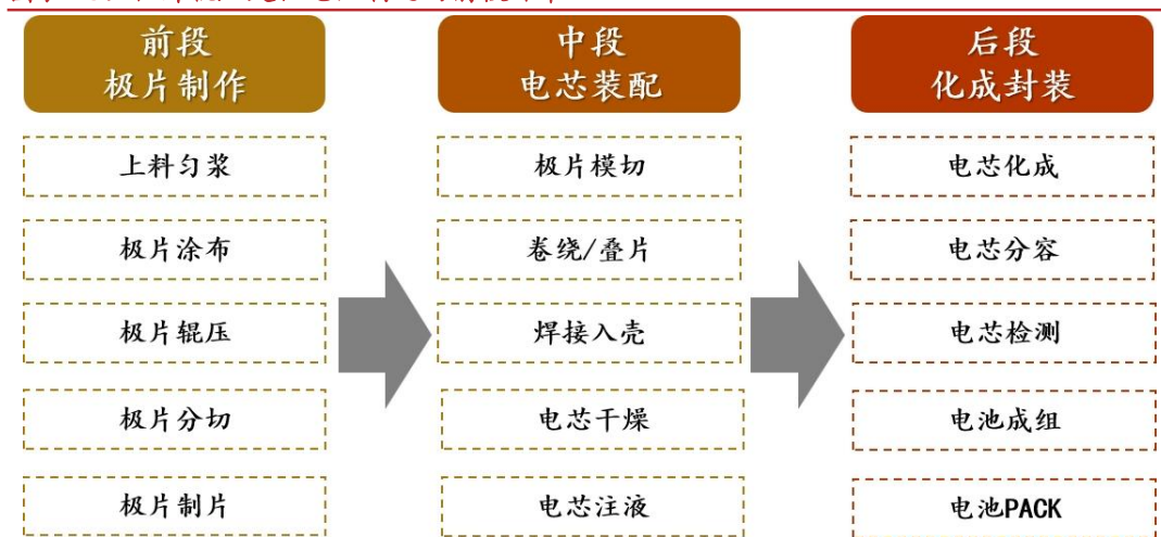
图表 18：极片辊压是锂电池制造的前段环节
