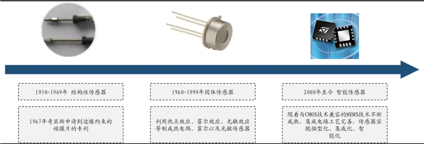
图9：传感器从1950年代结构性传感器已迭代至现代的智能传感器
