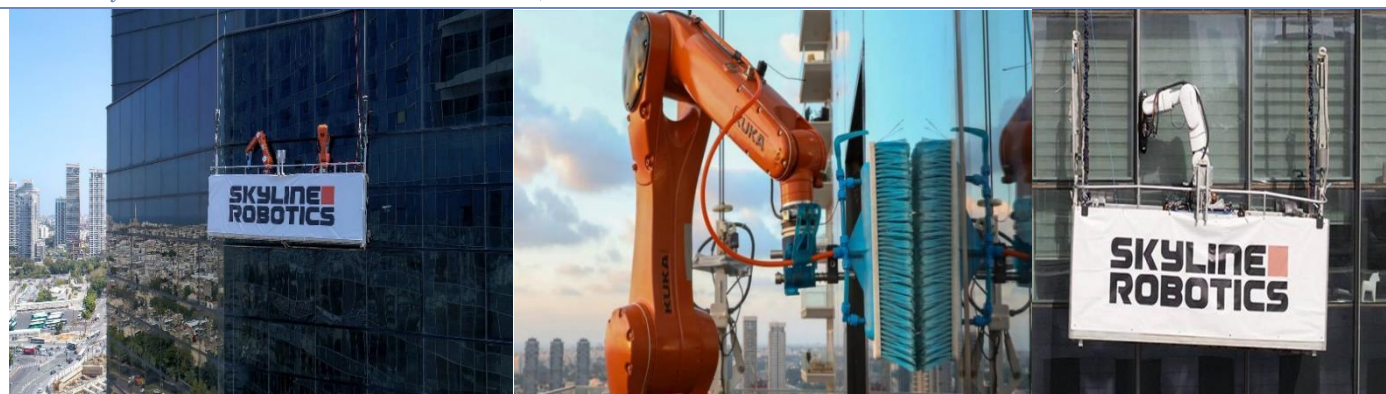
图16: Skyline Robotics 用 KUKA 机械手臂结合 AI, 提供摩天大楼擦窗的机器人解决方案
