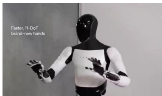
图50: Optimus Gen2 灵巧手 11 个自由度
