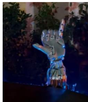
图51: Optimus Gen3 灵巧手 22 个自由度
