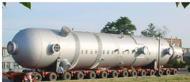
图7：多喷嘴水煤浆气流床加压气化炉
