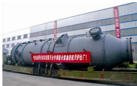
图8：航天干煤粉气流床加压气化炉
