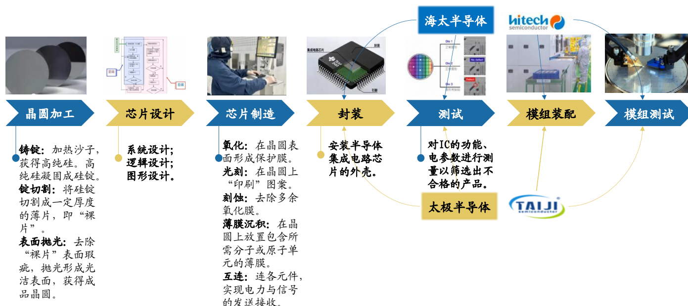
图 26: 半导体生产流程由晶圆加工、芯片设计、芯片制造、芯片封装和封装后测试组成
