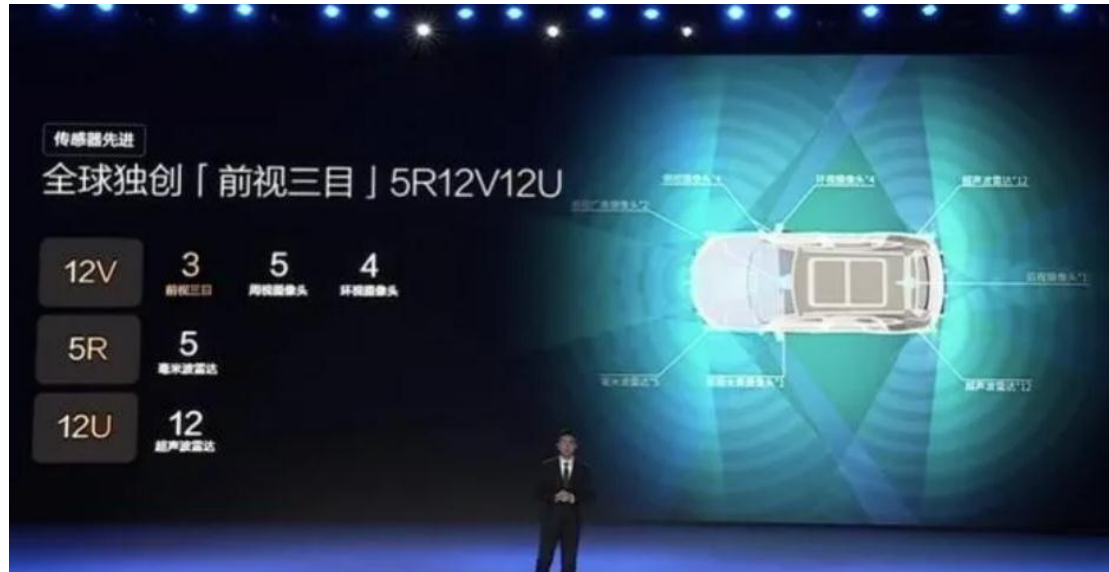
图5：比亚迪天神之眼C传感器构成：5R12V12U（12个摄像头、5个毫米波雷达和12个超声波雷达）
