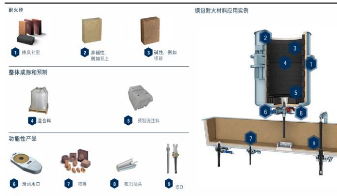
图 6：耐火材料的分类和在钢包的应用场景
