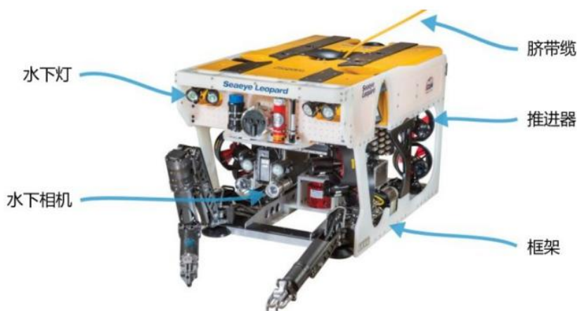
图表 1：ROV 的基本结构
