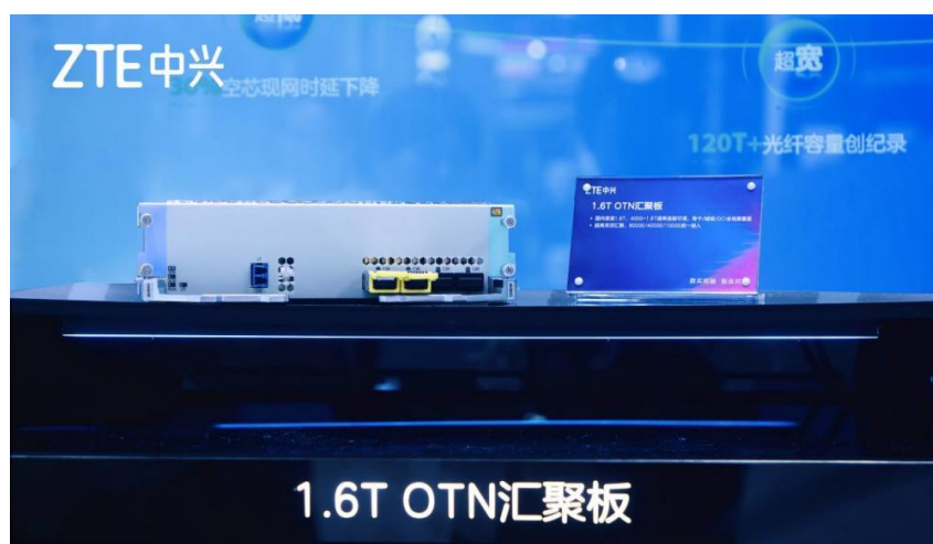
图27:公司发布国内首款面向智算中心算间互联场景的 1.6T OTN 样机
