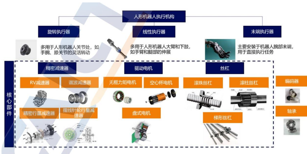
图表14：人形机器人三大执行机构
