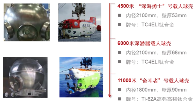
图表 10：宝钛研制的系列深潜器载人球壳，处于世界领先水平
