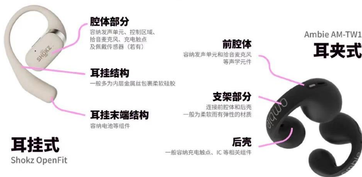
图 14 OWS 耳机结构
