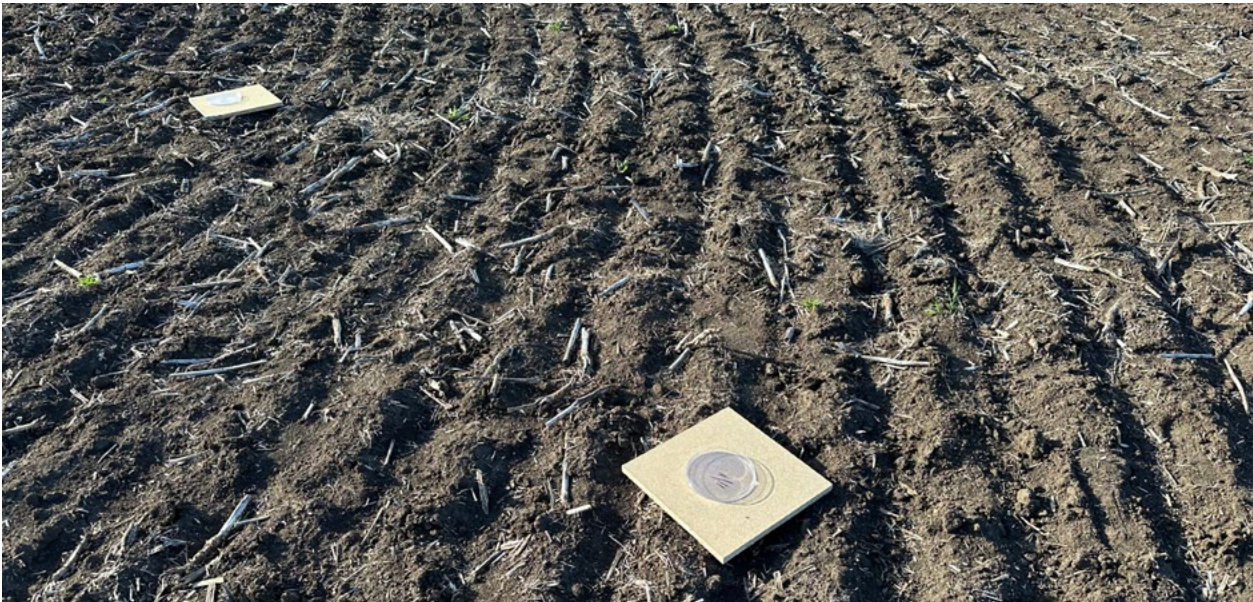
地面雨滴收集装置用于匈牙利漂移试验
