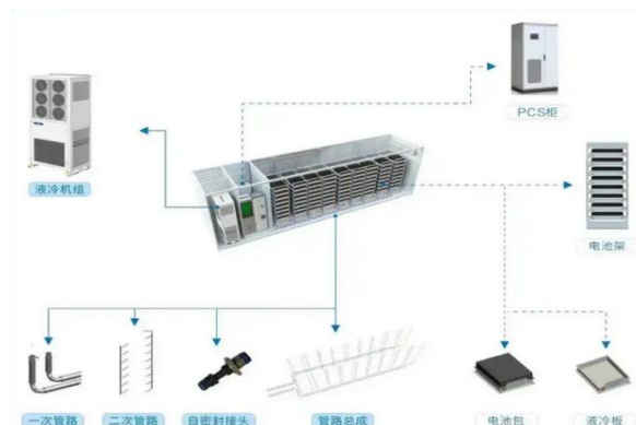
图28: 储能热管理中的液冷系统构成
