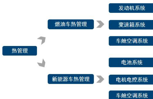
图13：传统燃油车及新能源纯电车热管理系统的构成对比
