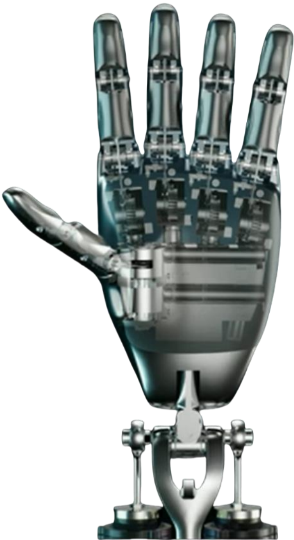
图表：特斯拉Optimus G1及G2使用的灵巧手（11个自由度）
