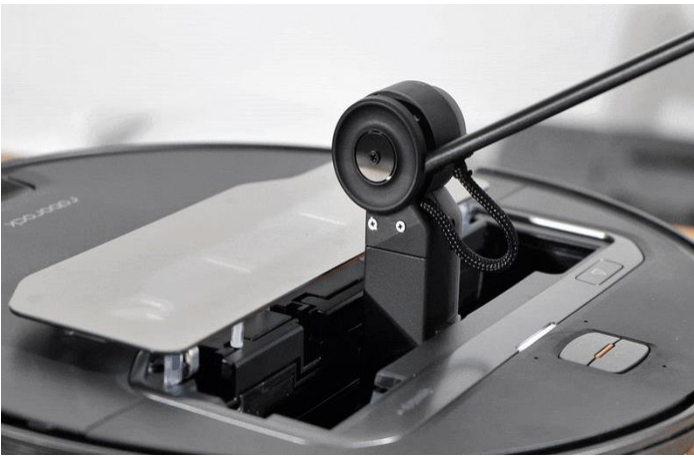
图表126: 石头 G30 Space 搭载了仿生机械手
