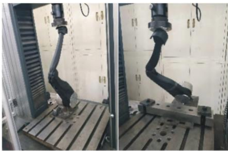
a) 连续碳纤维复合材料仿生腿两类工况测试
