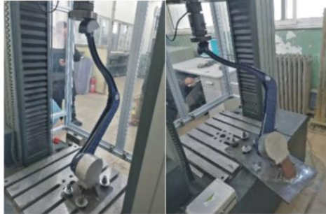
b) 铝合金材料仿生腿两类工况测试
