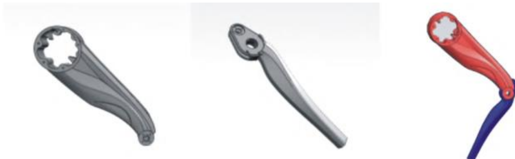
图表 22 四足机器人仿生腿结构简图
