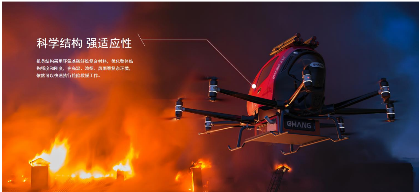
图表 21 亿航 216F（消防版）机身结构采用环氧基碳纤维复合材料
