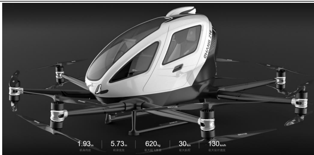
图7：亿航智能 EH216-S 高 1.93 米、最大航程 30km、最大设计速度 130km/h
