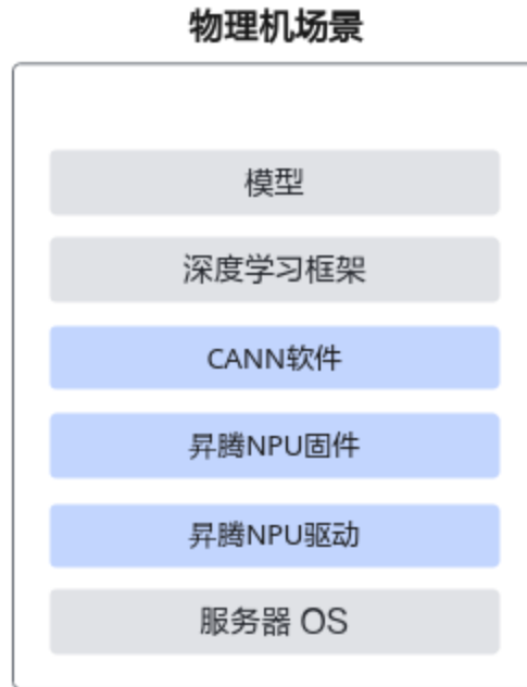
图 11：裸金属服务器所需安装软件栈
