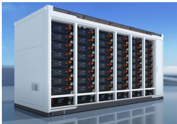
图 19: PowerTitan 2.0 储能系统实现“交直流一体”，直接将 PCS 集成在电池簇下方，省去了外置 PCS 柜
