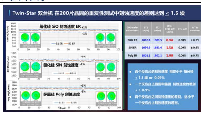
图 7：氧化硅、氮化硅和多晶硅各 200 片晶圆在双反应台上刻蚀速度的重复性
