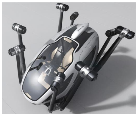
图6: EH216 机翼折叠收纳示意图
