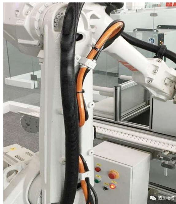
图62 远东300/500V工业机器人电缆
