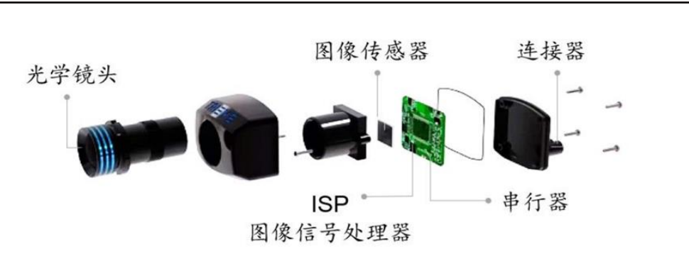
图49：车载摄像头结构
