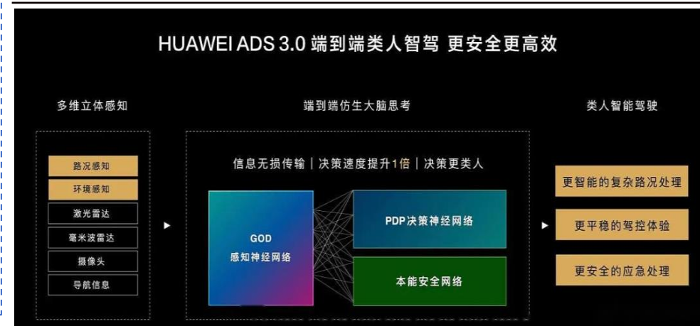
图25：ADS 3.0采用两段式端到端架构
