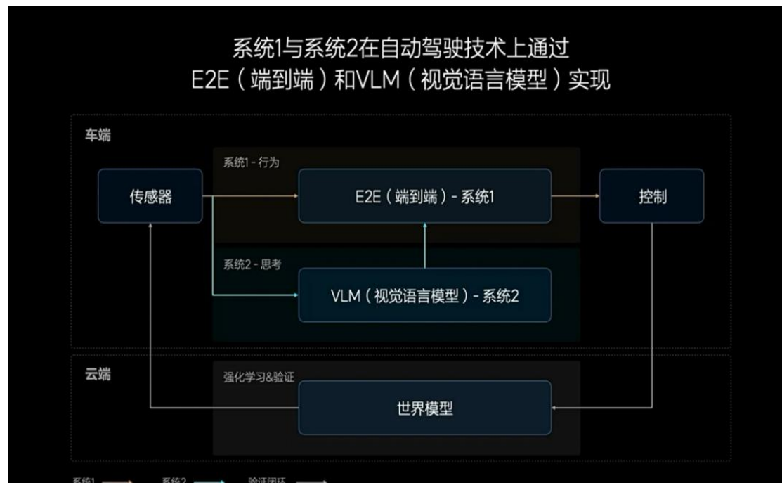
图32：理想汽车双系统架构
