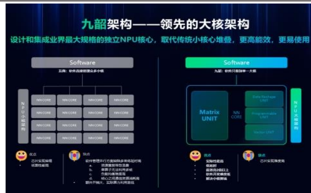
图73：九韶NPU架构
