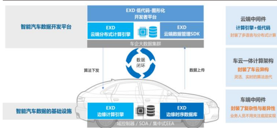
图43：车云一体计算架构
