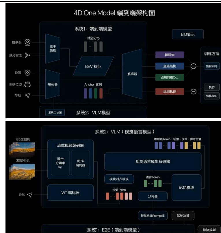
图33、34：系统1（端到端）&系统2（VLM）架构
