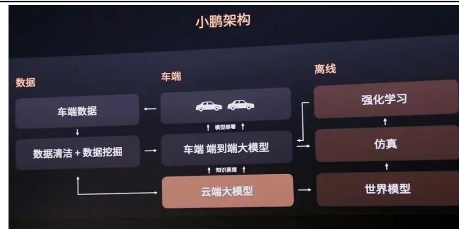
图29：小鹏汽车的端到端架构
