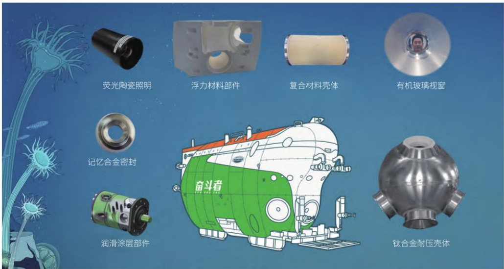
图11：深海观测探测平台应用的主要材料及部件
