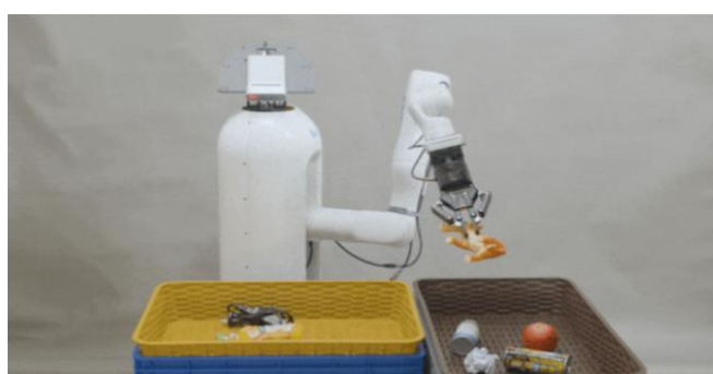
图30：GR-2 完成流畅端到端物体拣选示意图
