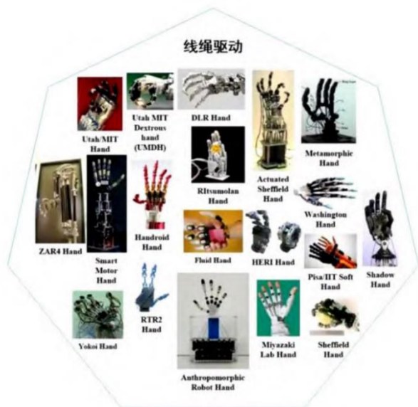
图表12: 腱绳传动是目前灵巧手中应用最广泛的传动方式
