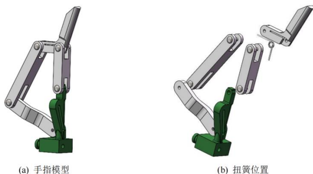
图表14：连杆传动多采用平面四杆机构传动
