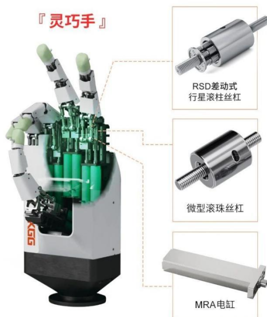
图表60: KGG 已经做出丝杠传动的灵巧手方案
