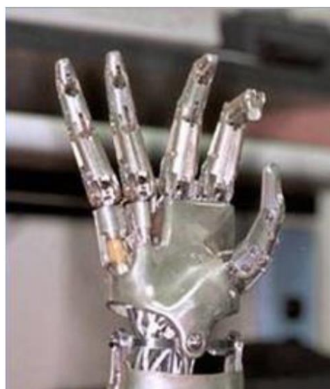
图表13: Robonaut Hand 等空间环境灵巧手采用腱绳驱动
