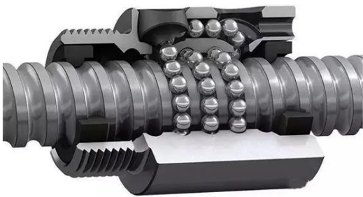
图表24：滚珠丝杠通过螺纹将旋转运动转化为平移运动
