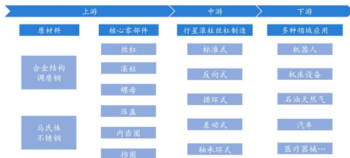
图表34：微型手部丝杠产业链构成
