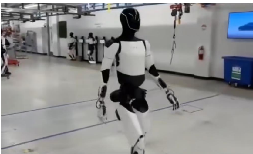
图表15: 特斯拉第三代擎天柱机器人改进臀部减速器步态稳定性提高
