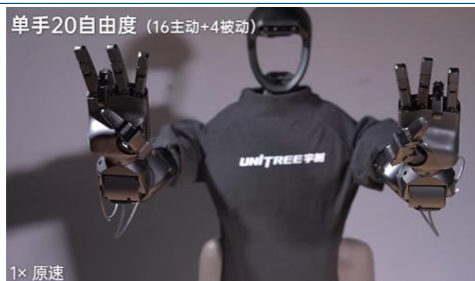
图表9：宇树科技发布 Unitree Dex5 灵巧手
