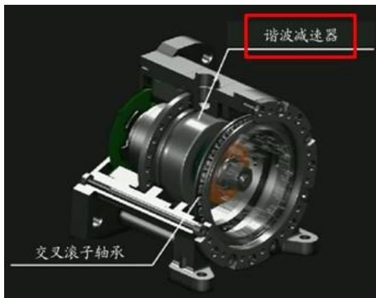
图17：特斯拉公开的旋转关节方案采用谐波减速器
