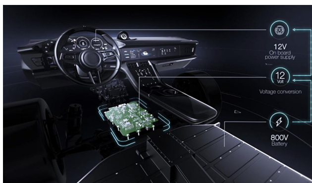
图25: 均胜电子车载功率电子器件
