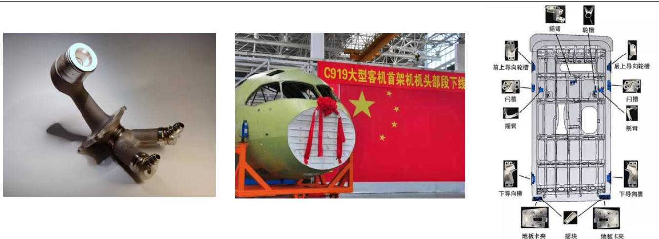
图3：C919 飞机中使用 3D 打印技术制造的零部件
