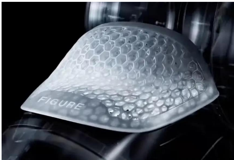
图25：Figure 02 人形机器人采用 3D 打印新型蜂窝状复合材料
