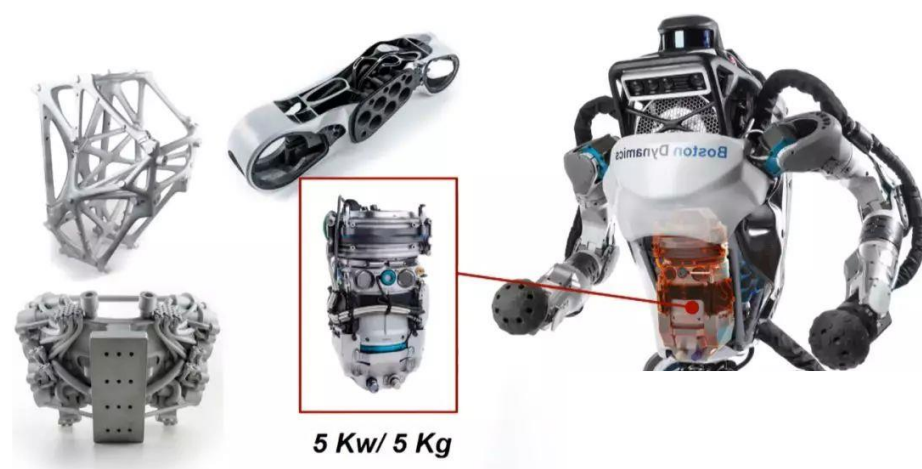
图22：3D 打印参与 Atlas 液压动力单元制造
